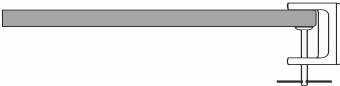
Abbildung 2 Montage der Halterung an der Tisch- bzw. Arbeitsplatte
